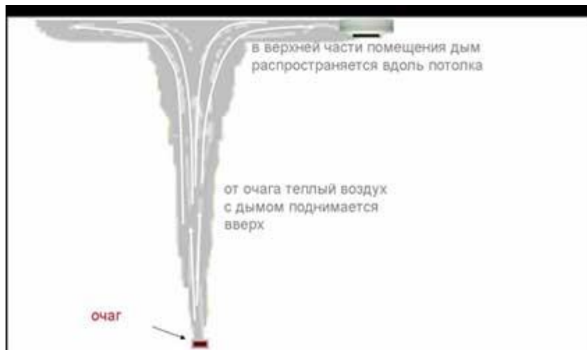
Рис. 2. Распределение дыма в помещении
